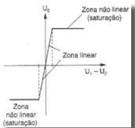
Fig. 2: Característica de transferência de tensão do amplificador em malha aberta
